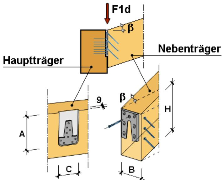
**Nachweis Anschluss eines Nebenträgers an einen Hauptträger mittels**
